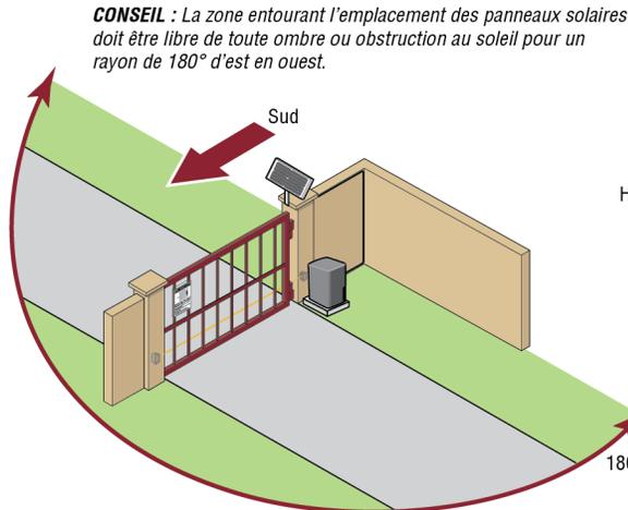
**CONSEIL :** La zone entourant l'emplacement des panneaux solaires doit être libre de toute ombre ou obstruction au soleil pour un rayon de 180° d'est en ouest.
