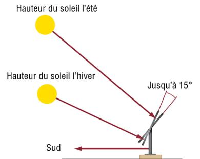
**CONSEIL :** Pour optimiser le fonctionnement du système en hiver, il est possible d'accroître l'angle de 15 degrés de plus (les panneaux sont assis davantage à la verticale).
